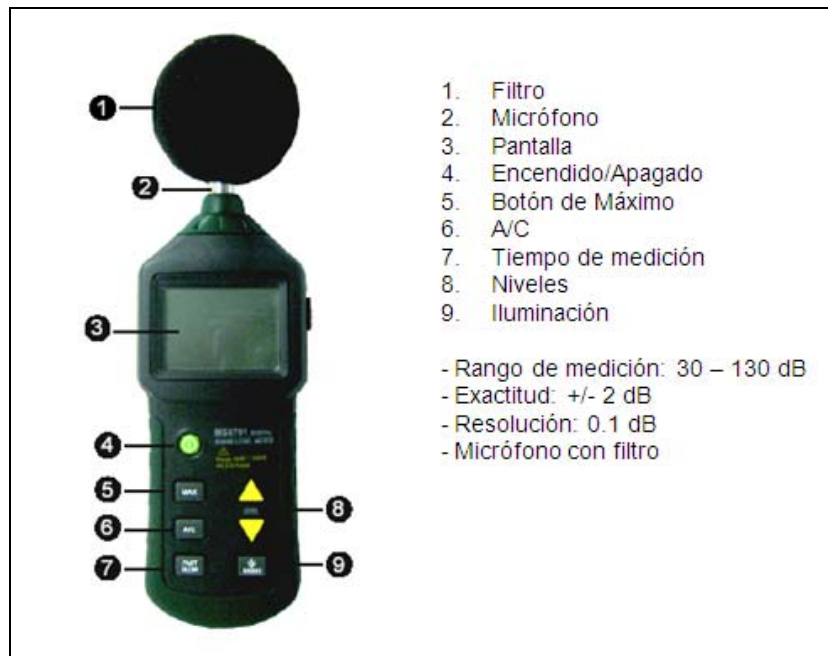
Figura IV.7. Esquema del decibelímetro digital (Sonómetro)
